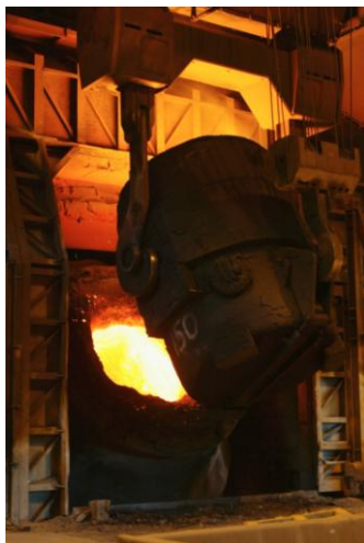
Raakaraudan panostus konvertteriin. SSAB:n Luleån tehtaasta, Norrbotten, 2002. Kuva: Stig-Göran Nilsson, JK:n arkistot.
