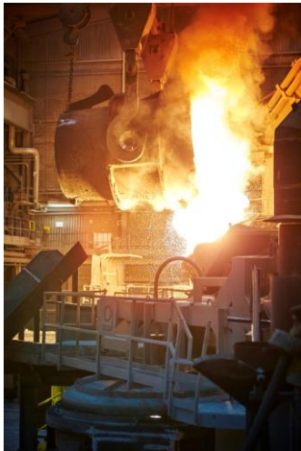
Raakateräksen panostus AOD-konvertteriin AB Sandvik Materials Technologyn tehtailla Sandvikenissä, Gästriklandissa, 2015. Kuva: Pia & Hans Nordlander (Jernkontoretin arkisto).
