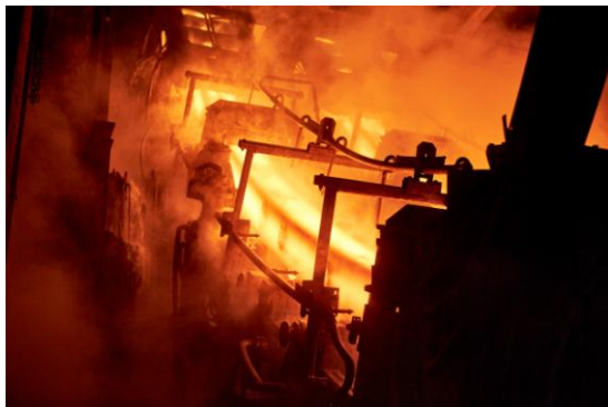
Teräksen jatkuvavalu AB Sandvik Materials Technologyn tehtailla Sandvikenissä, Gästriklandissa, 2015. Kuva: Pia & Hans Nordlander (Jernkontoretin arkisto).
