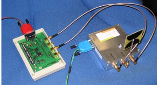
Fig. 2. UWB pulse generator.
